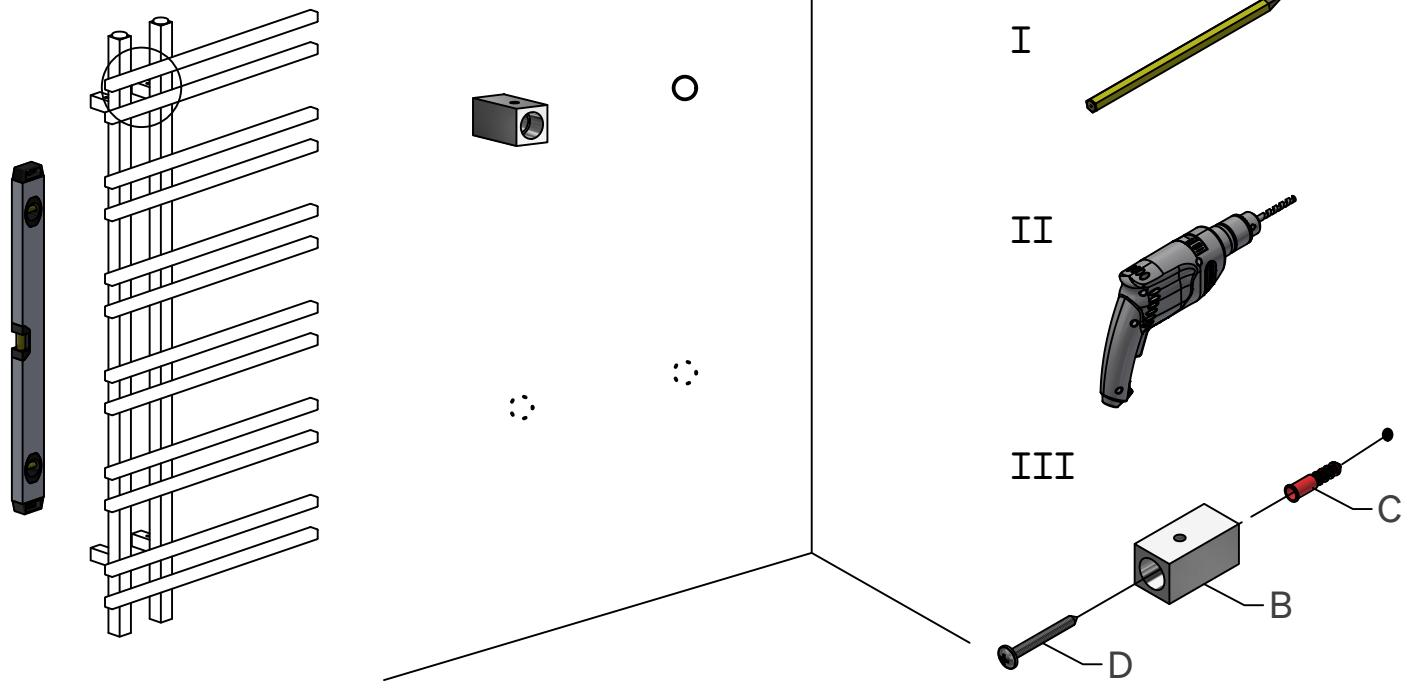
Skrufinfästningar ska göras i betong eller annan massiv konstruktion, träreglar,träkortlingar eller i konstruktion som är provad och godkänd för infästning, till exempel skivkonstruktion. Se exempel på godkända konstruktioner på säkervatten.se.
